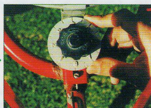
開孔部の開度は8に設定します
