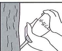
孔の空気を抜くため、容器の胴の部分を2~3回強く押して下さい。
