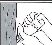
容器の底にある空気抜き穴に、所定の針を刺し空気穴を開けて下さい。
